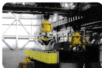
プラ容器包装クレーン
